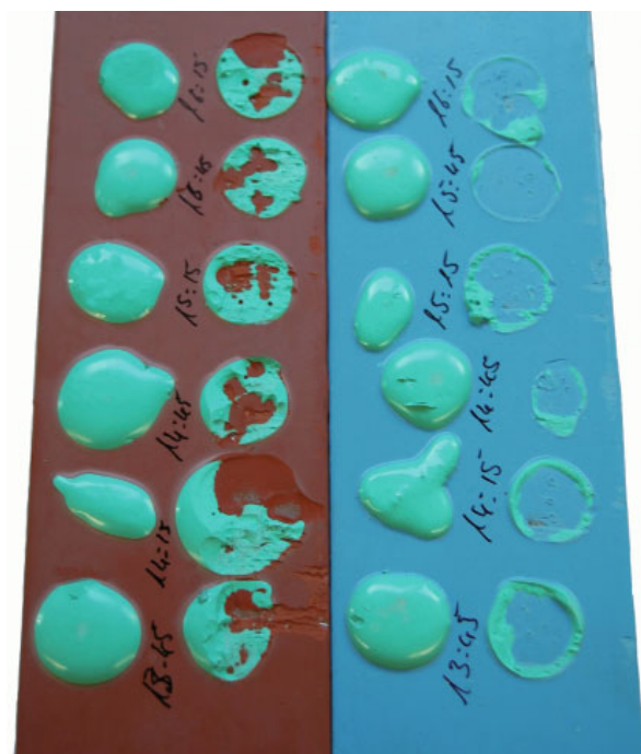
Bild 3. Vergleich der Zwischenlagenhaftung von LF-TWB 500 (rot) mit einem herkömmlichen System (blau) bei 10 °C und 75 % rF. Deutlich zu sehen ist die um mindestens 2,5 h längere Haftung.
