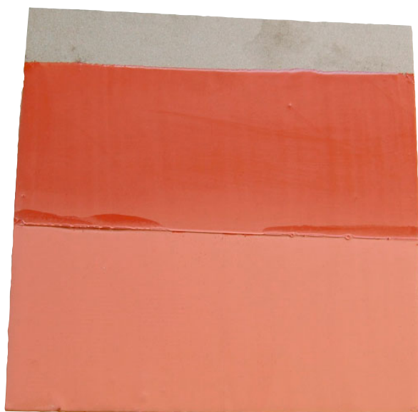
Bild 4. Edelstahlplatte beschichtet mit LF-TWB 500. Die Platte wurde mit noch weicher Beschichtung in ein geschlossenes, teilweise gefülltes Wassergefäß gestellt. Zu sehen ist die nur leicht mattierte obere Hälfte (100 % Luftfeuchtigkeit), die mattere untere Hälfte (flüssiges Wasser) und die Wasserstandslinie.
