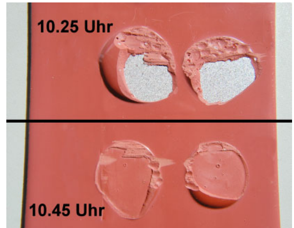
Bild 2. Kompletter Verlust der Zwischenlagenhaftung innerhalb von 20 Min. nach einer Gesamtzeit von 90 Min. bei einem herkömmlichen hochreaktiven Epoxidharzsystem bei 20°C und 75 % rF.
