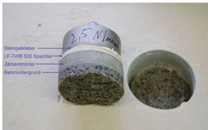
Bild 1. Haftzugprüfung an Mörtelprobe, die im frischen Zustand überbeschichtet wurde.
