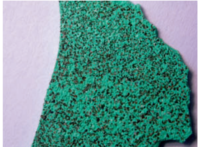
Abb. 6: Rückseite einer sich ablösenden Epoxydharzdeckbeschichtung. Das Abstreukorn haftet auf der Rückseite der Deckbeschichtung, die Einbindung in der darunter liegenden Schicht war mangelhaft
