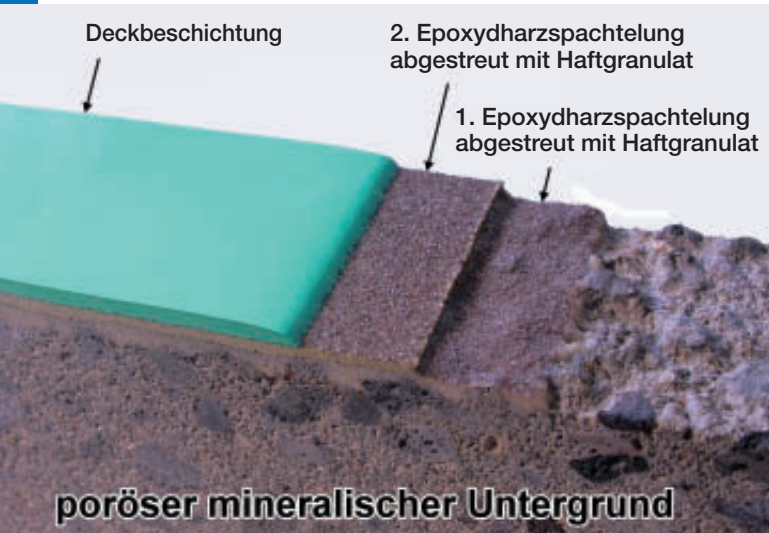
Abb. 7: Aufbau eines Epoxydharzsystems auf Beton mit zwei abgestreuten Spachtelschichten und einer Deckbeschichtung
